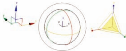
Tri transformaciona kontrolna objekta
